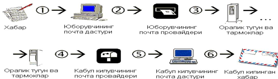
**1-расм. Электрон почта хизматининг ишлаш схемаси.**
