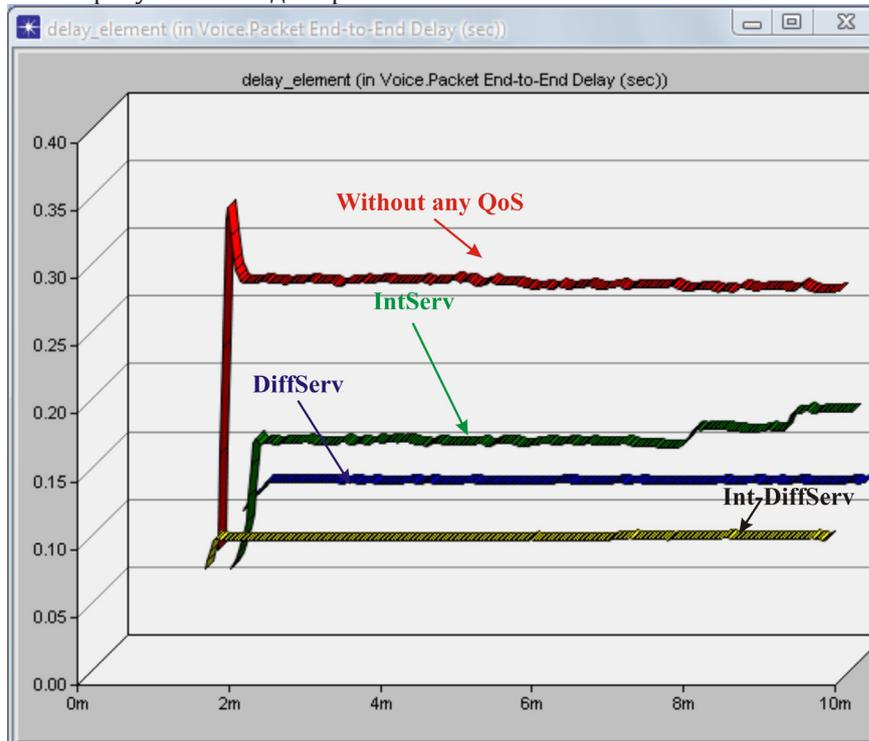
Рисунок.2. Задержка при передаче голосового трафика
