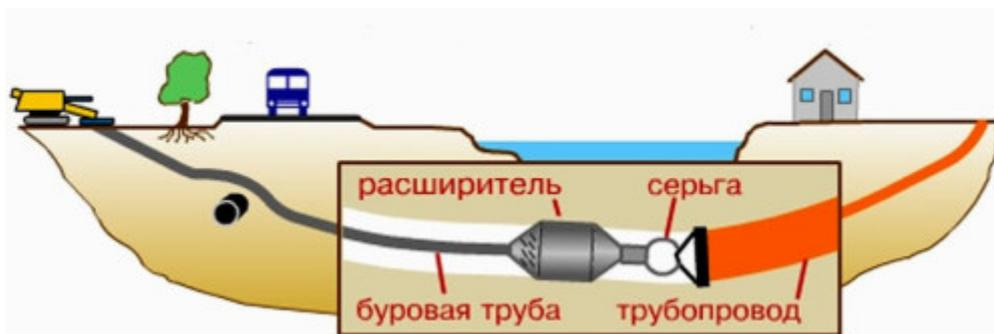
Рис. 3. Схема прокладки трубопровода методом прокола
