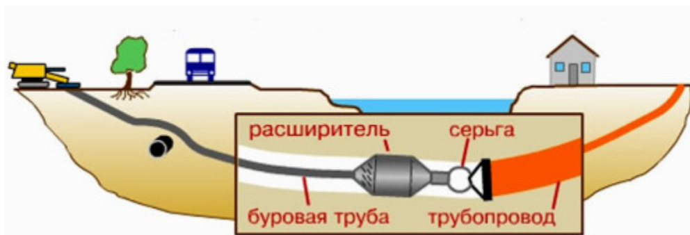
Рис. 3. Схема прокладки трубопровода методом прокола
