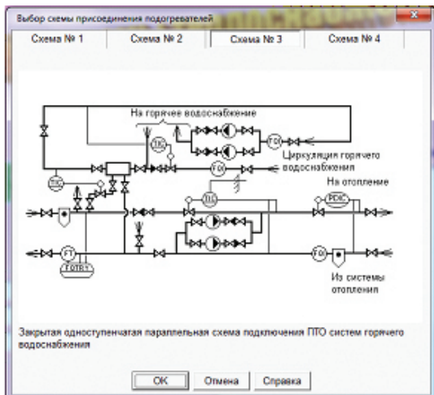
в) закрытая одноступенчатая параллельная схема подключения ПТО систем горячего водоснабжения;
