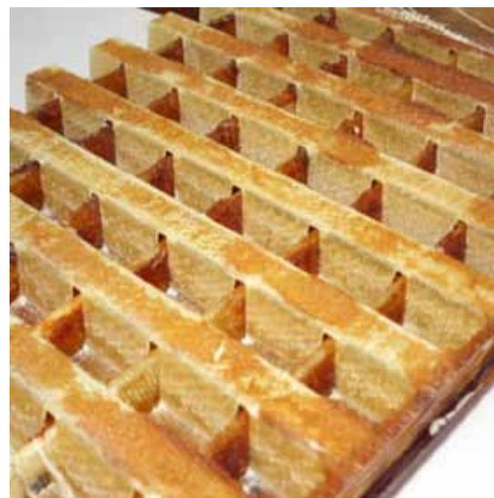
Рисунок 3. Ячеистый наполнитель
