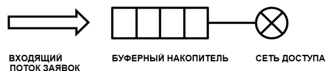
Рисунок 1. Обобщенная схема модели СМО для фрагмента сети
