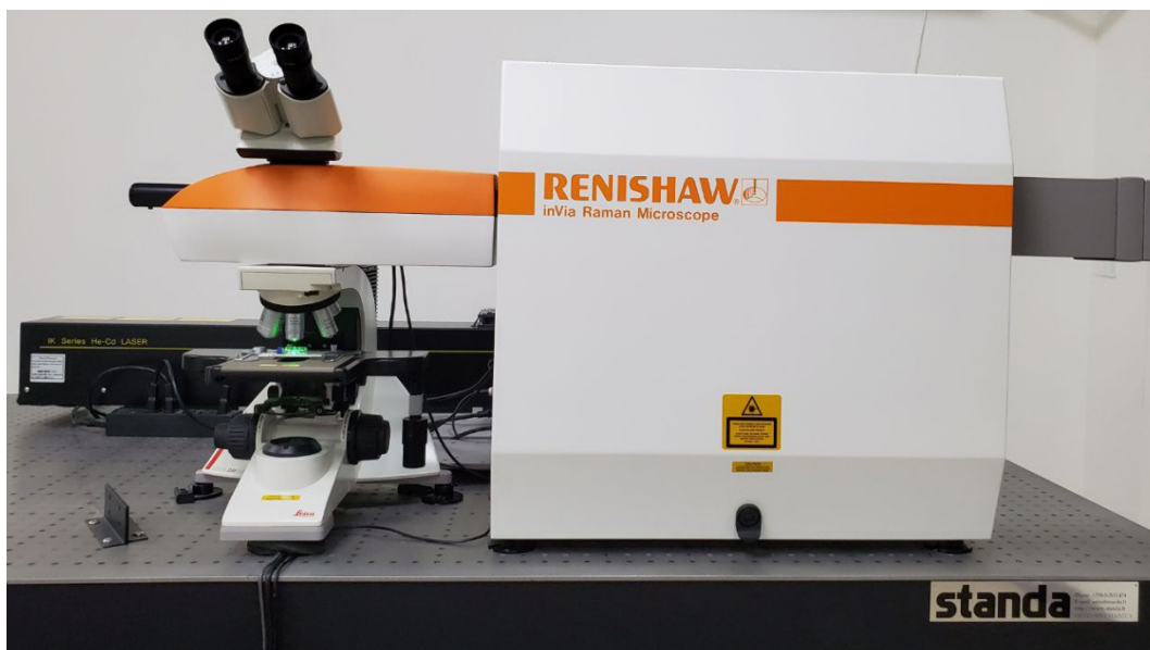
Рис.3. InVia Raman спектрометр производства компании «Renishaw», Великобритания
