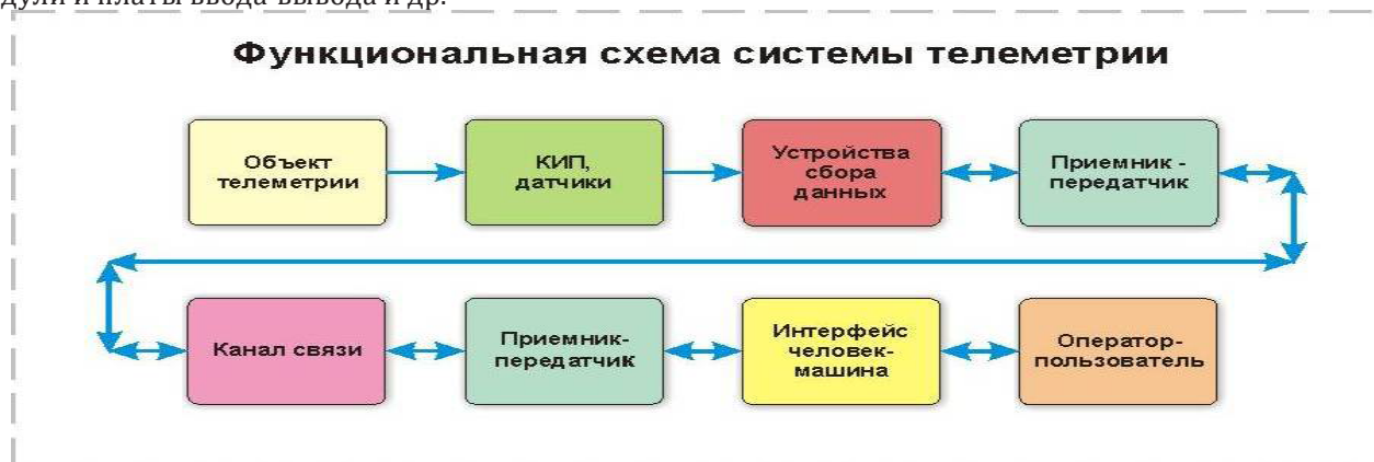
Рис.1. Функциональная схема системы телеметрии
