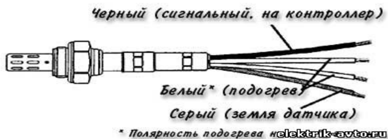
Рис. 5. Проводка лямбда датчика.
