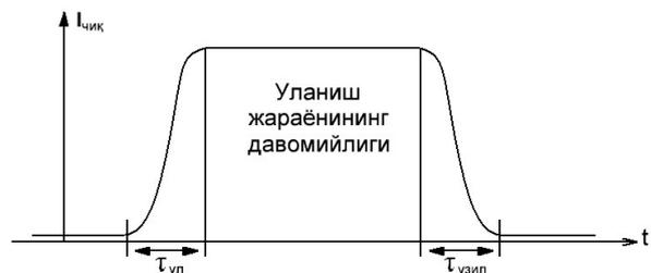
2-расм. Оптоэлектрон коммутатор ёрдамида алоқа тармоғидаги уланиш ва узилиш жараёнларининг динамикаси
