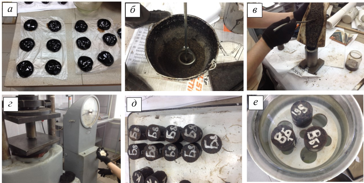
Рис. 1. Этапы приготовления образцов битуминизированного грунта
