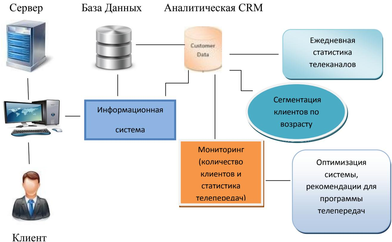
Рис.1 Схема работы информационной системы CRMTV
